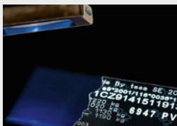
**UV-Footprint:** Nachweis für entfernte Labels durch permanente Markierung des Substrats.
